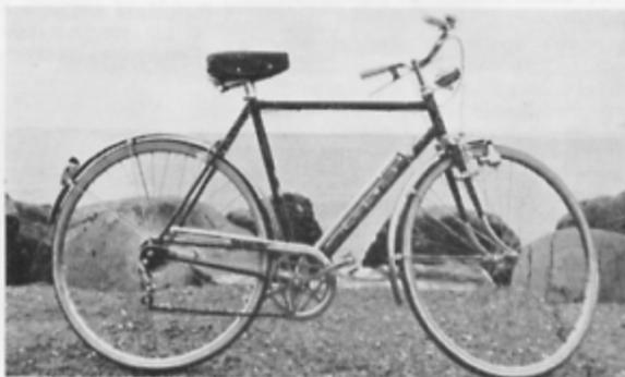
Peso kg 14,500 - Telaio e forcella in tubi Falck di precisione - Copricatena a striscia, cromato - Parafanghi spessori 5 decimi in acciaio inox, profilo sport stretto - Cambio Campagnolo - Guarnitura con ingranaggio da 46 denti - Catena 1/2 x 3/32 e ruota libera quadrupla - Sviluppo pedalata: denti 15 (m 6,85 - 17 (m 6,05) - 19 (m 5,40) - 21 (m 4,88) - Manu-
